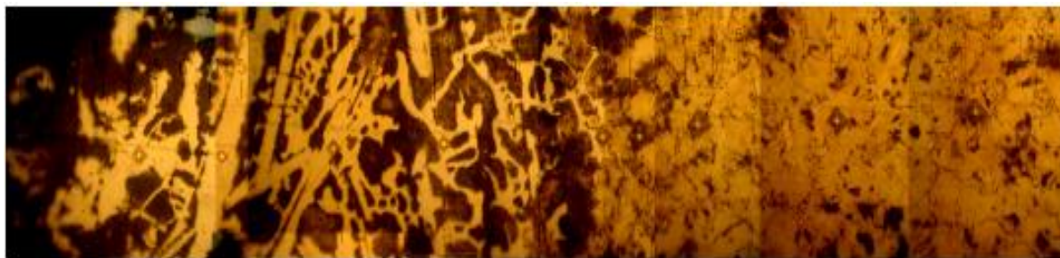
Рисунок 3 – Микроструктура борированного слоя в высокопрочном чугуне ВЧ 40-15
