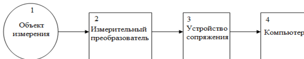
Рисунок – Структурная схема устройства: 1 – объект измерения; 2 – измерительный преобразователь; 3 – устройство сопряжения; 4 – персональный компьютер
